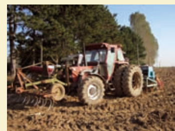
Un tasse-avant et des roues jumelées sur le tracteur limitent les risques de compaction du sol
